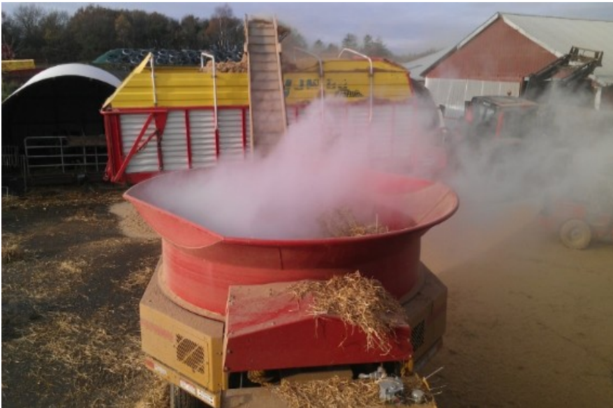
I stille perioder i den øvrige produktion grovsnittes halmballerne i en HayBuster.
